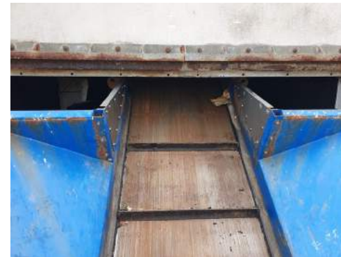
Conception et réalisation de 2 déflec- teurs pour le compacteur à déchets
